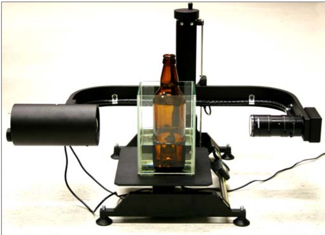
Joonis 4. Automaatpolariskoop AP-07. Immersioonivannis on mõõdetav pudel.
