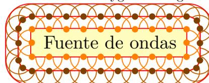
En el caso de las ondas de luz, una vez que tenemos el patrón de frentes de onda, los rayos de luz serían las curvas que están perpendiculares a los frentes de onda en todas partes.
