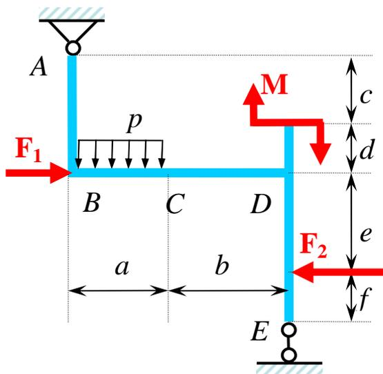
Raam on punktis A kinnitatud liikumatu liigendiga ja punktis B kerge vardaga. Talle mõjuvad jõupaar momendiga  $M$ , joonkoormus intensiivsusega  $p$  ja koondatud jõud  $F_1$  ning  $F_2$ .
